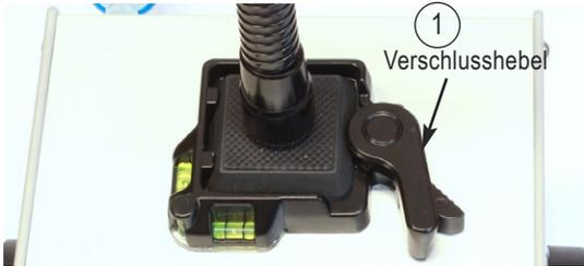
Bild 17 Medienhalter ist eingesetzt
