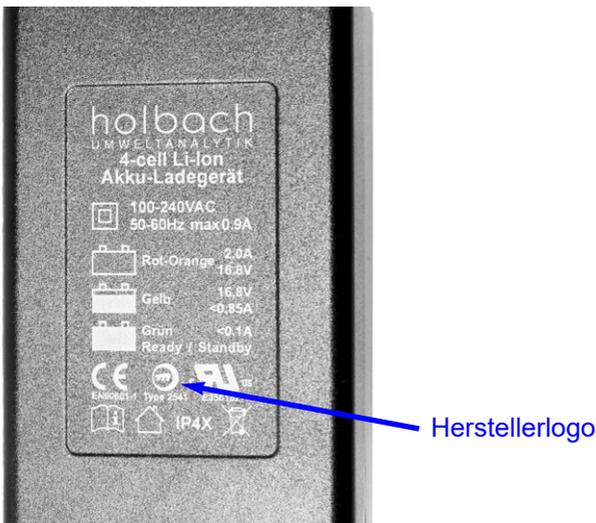
Bild 14 Die Rückseite des Ladegerätes mit Angabe der Statusfarben, Prüfzeichen und dem Herstellerlogo
