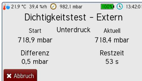
Bild 49 Der externe Dichtigkeitstest
