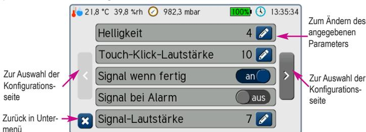
Bild 42 Die erste Konfigurationsseite der Geräteeinstellung
