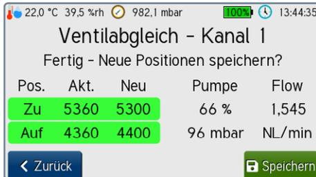
Bild 47 Ventilabgleich wurde am Kanal 1 durchgeführt
