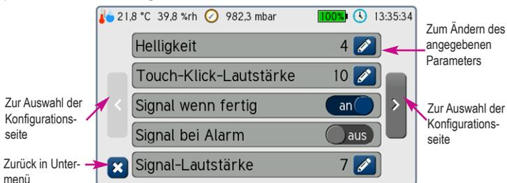
Bild 42 Die erste Konfigurationsseite der Geräteeinstellung
