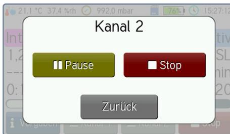
Bild 24 Dialog zum Unterbrechen oder Abbrechen der Probenahme
