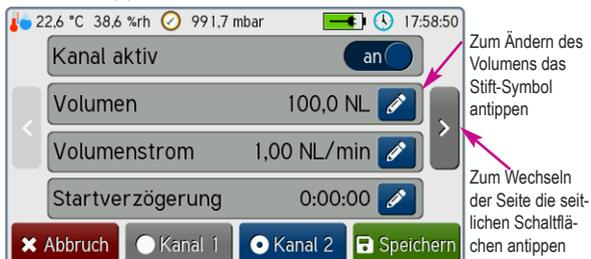
Bild 33 Der Kanal 2 wurde zur Änderung selektiert
