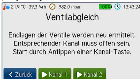
Bild 46 Ventilabgleich -Selektion des Kanals für den Abgleich
