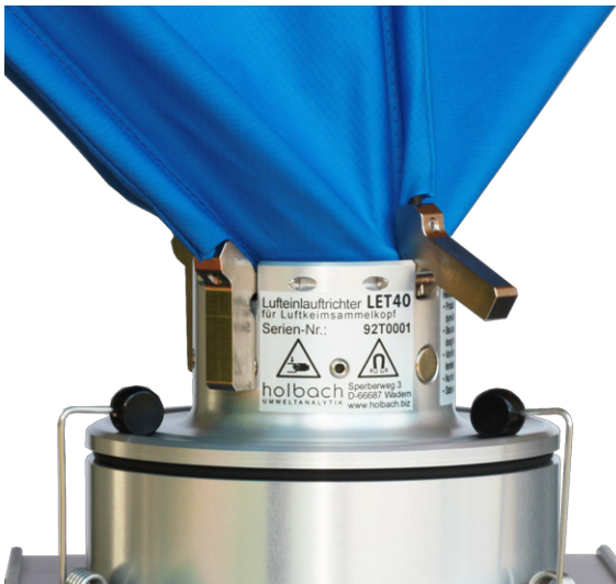
Neodym-Magnete halten die Federstahlstäbe in den Endlagen
