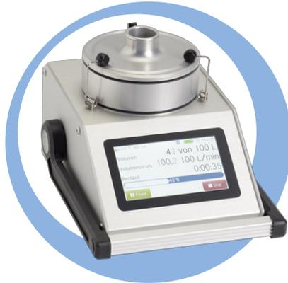
Zur Luftprobenahme von **kultivierbaren** Partikeln auf Nährmedien in 90-mm-Standard-Petrischalen steht der leistungsfähige Luftkeimsammelkopf **LKS100** mit einem Nennvolumenstrom von 100 l/min zur Verfügung. Der Luftkeimsammelkopf **LKS100** wird mit dem akkubetriebenen Probenahmesystem **MBASS30** betrieben.
