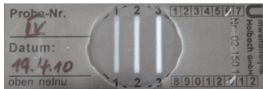
Bild 56 Total überladene Partikelspuren (nicht auswertbar)
