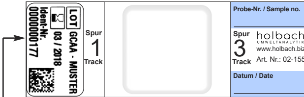
Bild 58 Beschichteter Objektträger 76 mm x 26 mm x 1 mm
