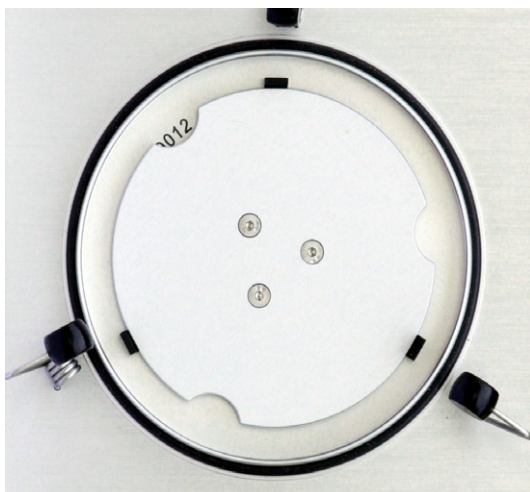
Bild 6 Medienzentrierung eng, Einstellscheibe auf 12
