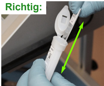
Bild 61 Position des Objektträgers bei Entnahme oder Einschoben
