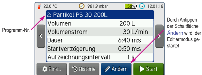
Bild 24 Diese Voreinstellung soll geändert werden
