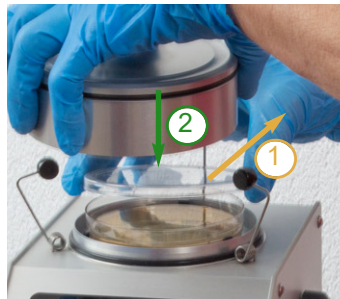
Bild 49 Deckel entnehmen, Sammelkopf aufsetzen
