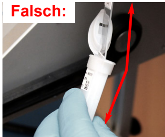
Bild 61 Position des Objektträgers bei Entnahme oder Einschoben
