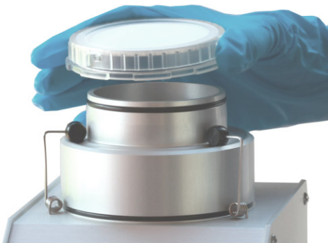
Bild 57 Aufsetzen eines Gelatinefilters in einer Einweeinheit
