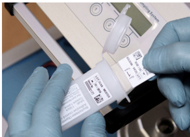
Bild 60 Entnahme des adhäsiv beschichteten Objektträgers
