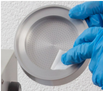
Bild 44 Düsenplatte oben reinigen
