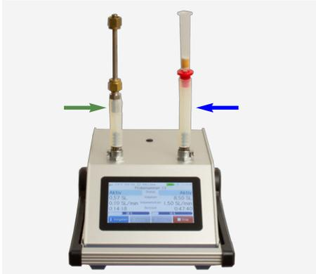
Das Foto zeigt den TENAX-Adapter (grüner Pfeil) auf dem linken Kanal der BiVOC2V2 im Einsatz. Die Gesamtwandstärke von 5 mm der kurzen Schlauchverbindung sorgt für eine stabile Position des Adsorbens während der Probenahme. Auf dem rechten Kanal ist der Adapter für die Supelco DNP-H-Kartuschen (blauer Pfeil) montiert. Beide Adapter sind so dimensioniert, dass sich die Ansaugung auf einer Ebene befindet.
