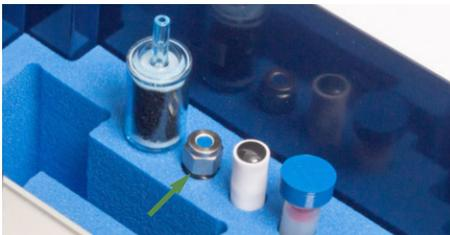
Für den Transport passt der TENAX-Adapter perfekt in eine der Bohrungen in der Schaumeinlage im Transportkoffer. Der zusätzliche Verschluss in der Kappe verhindert das Eindringen von Fremdkörpern in den Adapter.
