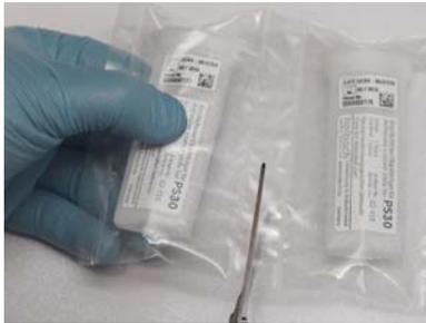
Durch die Doppel-Schweißnaht im Folienschlauch können die neuen Objektträger, wie bisher auch schon, einzeln abgetrennt werden.
