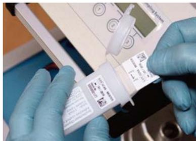
Der Objektträger kann nach dem Öffnen des Containers einfach entnommen werden.
