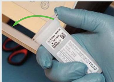
Nach Entnahme aus dem Folienschlauch wird der neue Versandcontainer durch einseitiges Aufdrücken des Deckels geöffnet.
