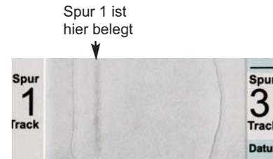
Die drei Spuren werden beim neuen Objektträger durch Markierungen links und rechts der Beschichtung identifiziert.
